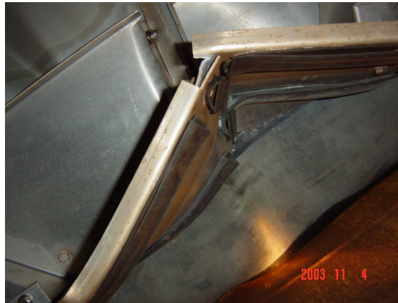
図 4.2-4 アウターリムプレート損傷状況
